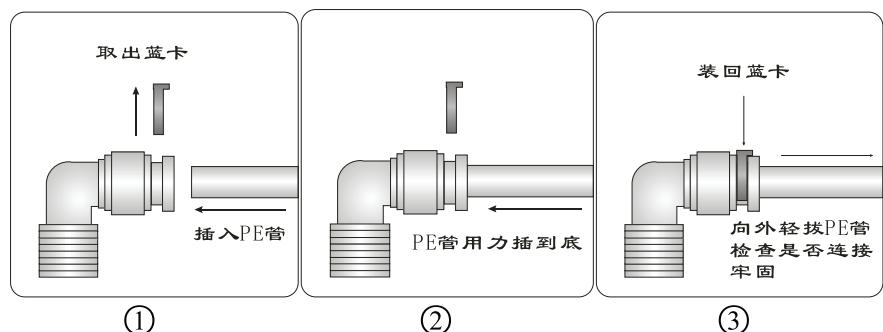
注：蓝卡不可丢失，连接完成后必须安装蓝卡，以防漏水。
