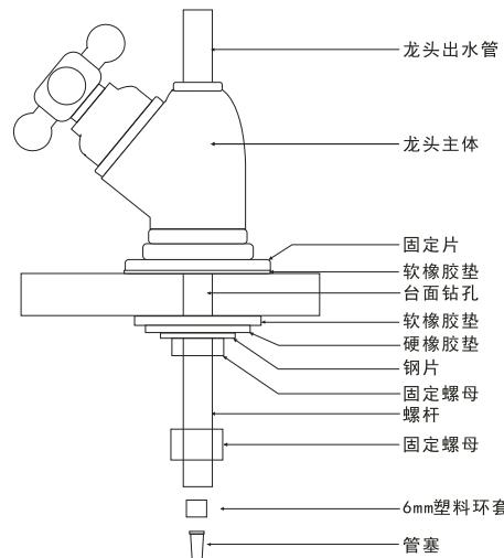
注：6mm的塑料环套和管塞在安装时不可丢失，否则会导致漏水。PE管与
