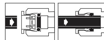
拆卸白管时，应该用手指压紧接头上的卡环，才能拔出白管
