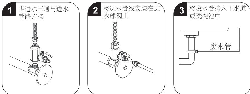
厨下三通进水安装步骤 ② 将进水管、废水管、电源与主机连接
