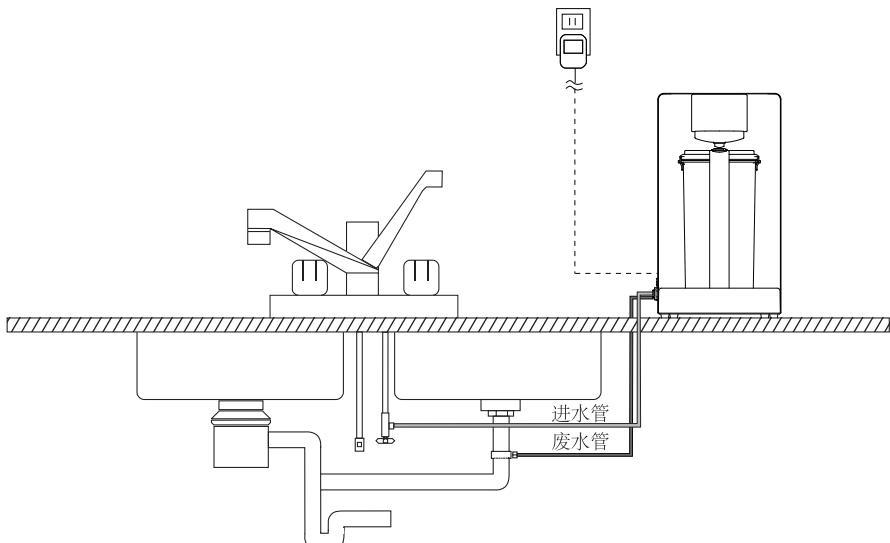
厨下三通进水安装步骤 ① 用进水三通与进水管路连接，并连接废水管
