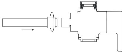
松开切换阀的进水软管连接螺母，
