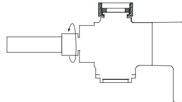
将进水软管压入切换阀
